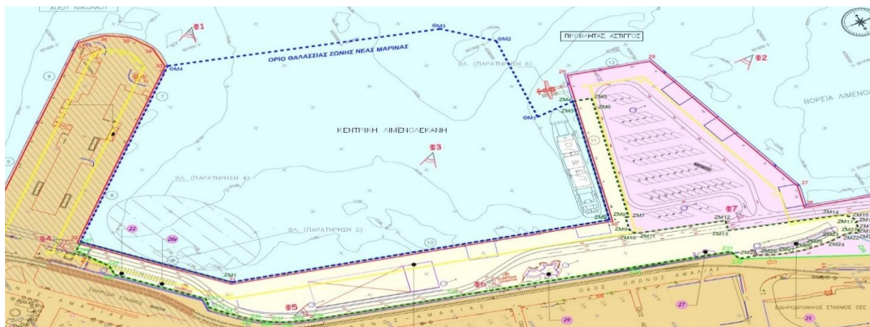
Εικόνα 2 Υφιστάμενη κατάσταση Κεντρικής Λιμενολεκάνης Βόρειου Λιμένα Πατρών και οριοθέτηση χερσαίας και θαλάσσιας ζώνης νέας μαρίνας
